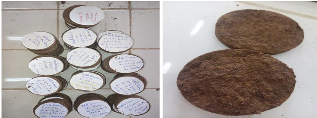
Figure III.25 : Echantillons après l'essai de cisaillement : (a) stockage des échantillons et (b) inspection visuelle des déplacements
