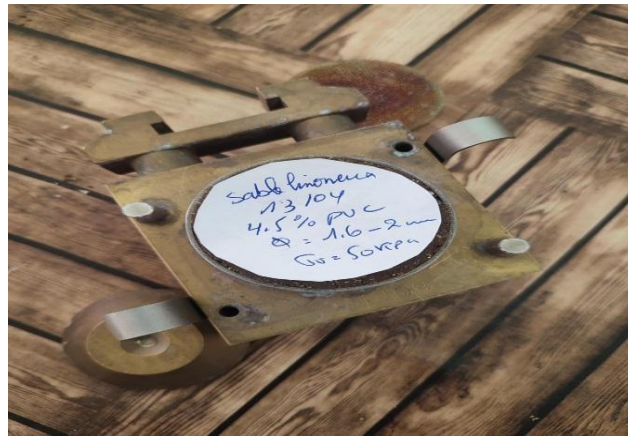
Figure III.18 : positionnement de l'échantillon dans la boîte
