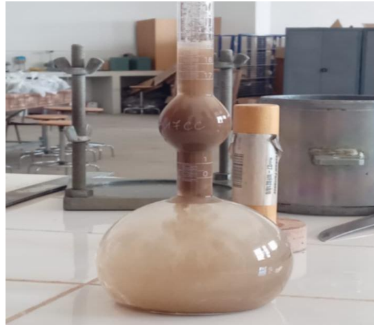
Figure III.8 : Essai de la masse volumique absolue du sable limoneux.
