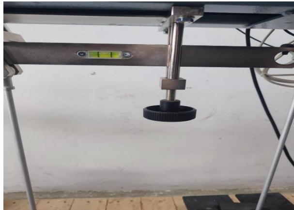
Figure III.21 : Ajustement du niveau avant l'essai
