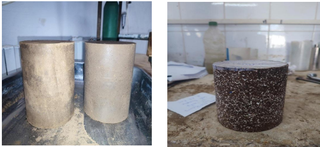
Figure III.15 : Eprouvettes après démoulage
