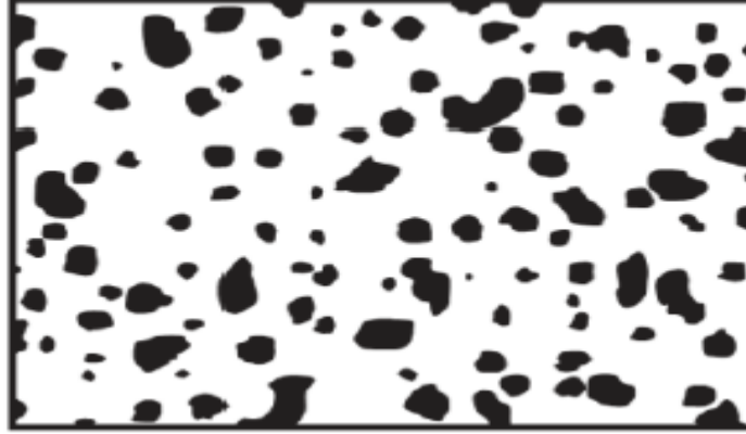
Figure I.13: Matériau FGM à deux phases avec microstructure particulaire
