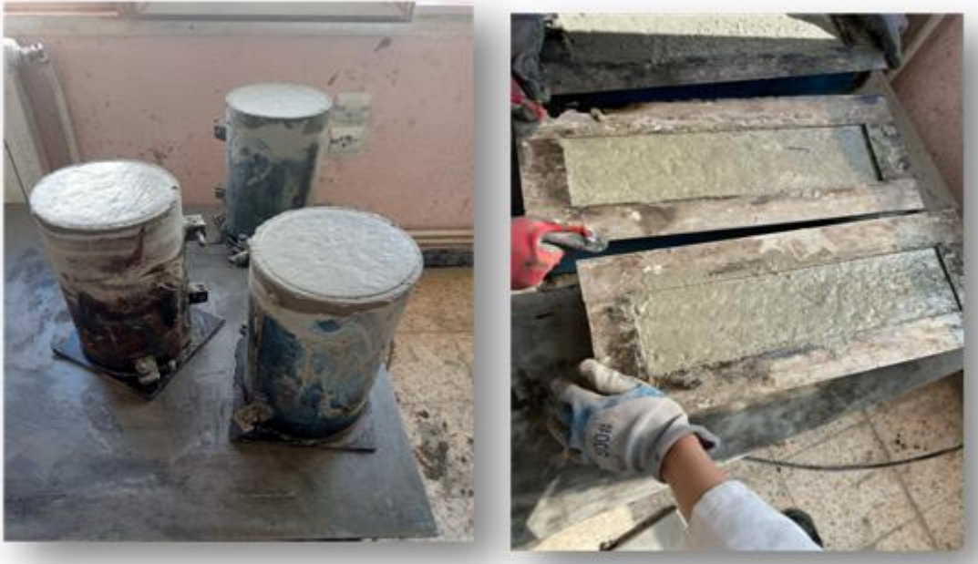
Figure 3.16 : Vibration de béton.
