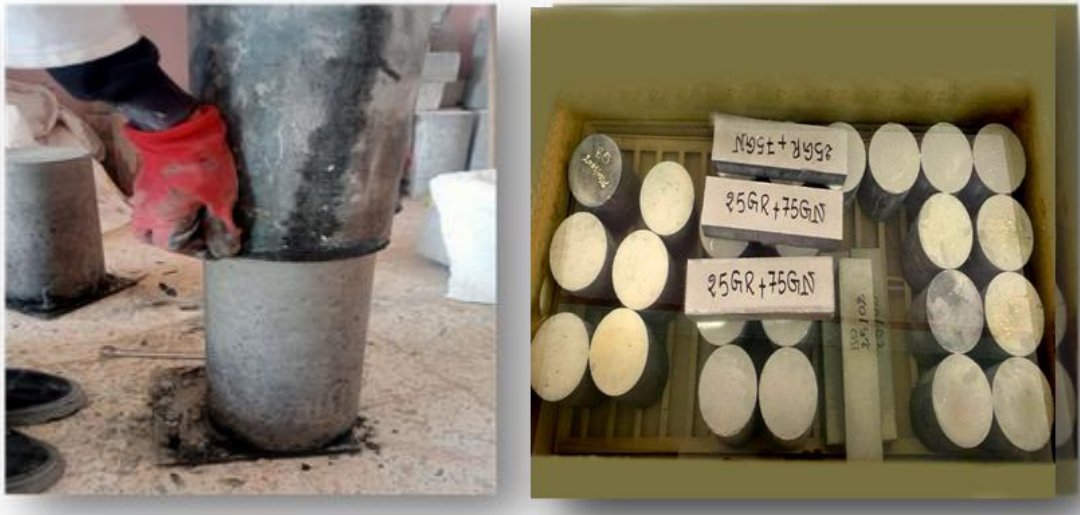
Figure 3.17: Démoulage et conservation des éprouvettes dans l'eau.
