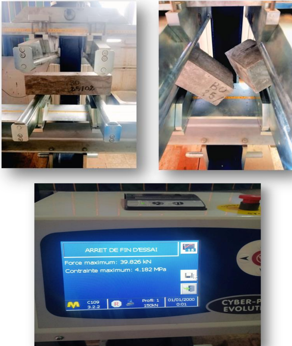
Figure 3.22 : Essai de traction par flexion.
