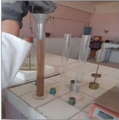
Mise en place de l'échantillon de sable dans l'éprouvette
