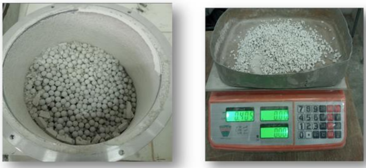
Figure 3.13: Essai de Micro- Deval sur (a) gravier naturel, (b) gravier recyclé.
