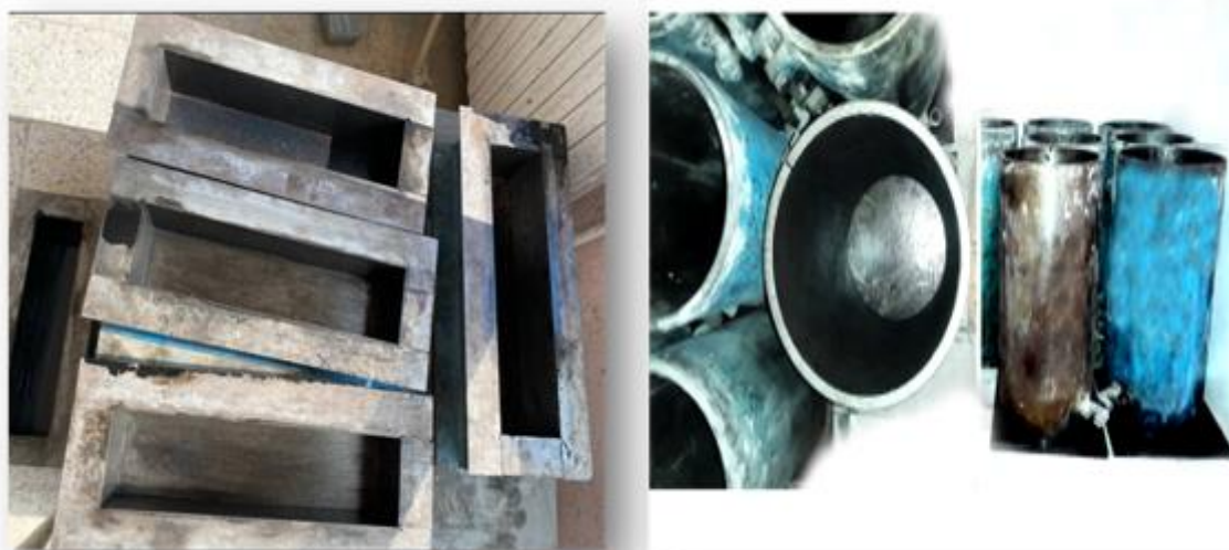
Figure 3.14 : Epreuves (cylindriques 16x32cm 2 et prismatique 10x10x40 cm 3 ).
