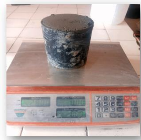
Figure 3.19: Détermination de la masse volumique à l'état frais.
