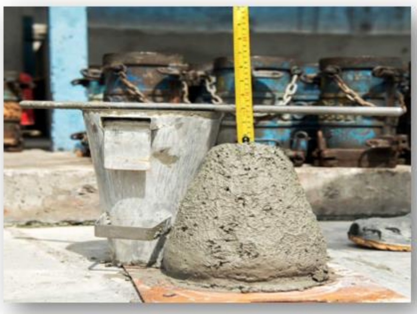
Figure 2.2 : Essai d'affaissement au cône d'Abrams [MonCoffrage.com].
