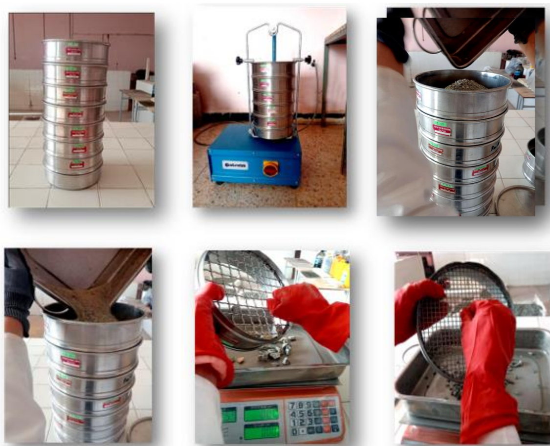
Figure 3.7 : Procédé d'analyse granulométrique des granulats.
