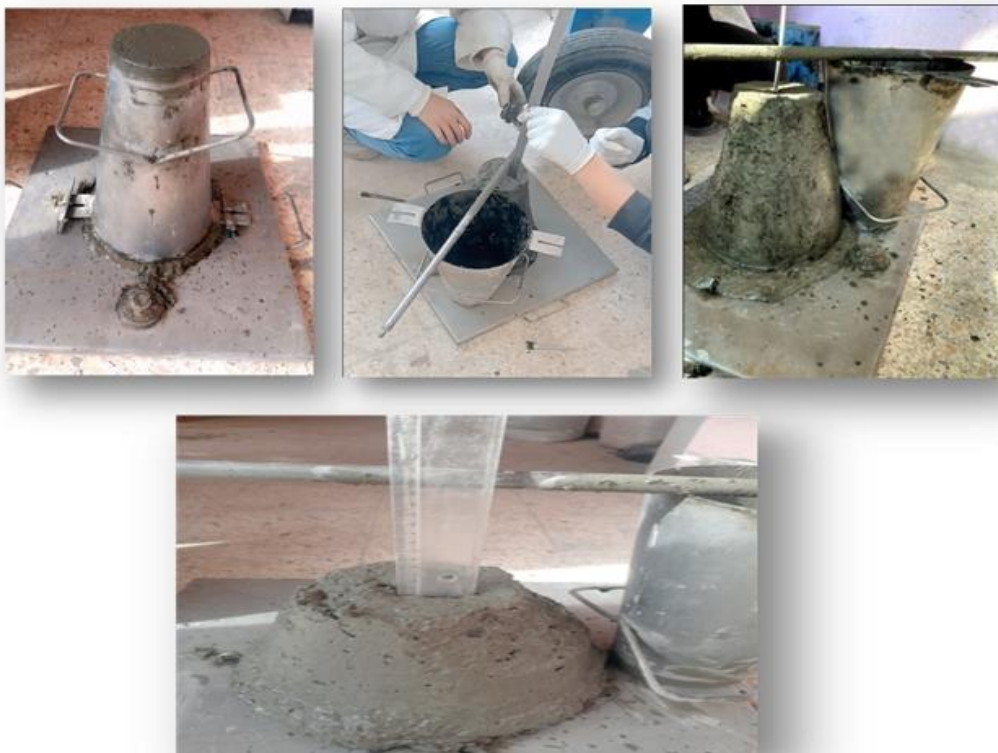
Figure 3.18 : Affaissement au cône d'Abrams.
