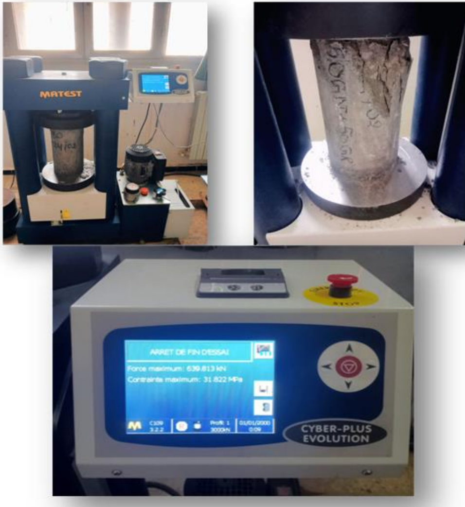
Figure 3.21 : Essais de compression des éprouvettes cylindriques (16x32) cm 2 .
