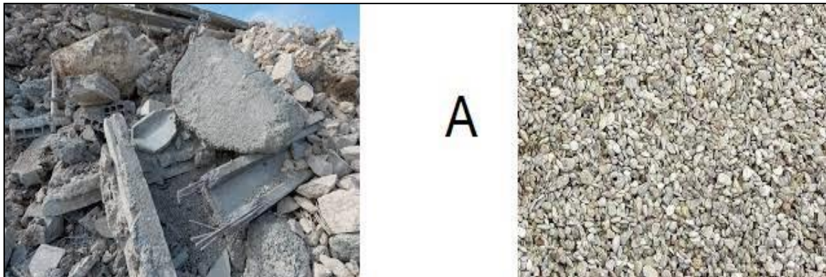
Figure 1.14: A- granulats de béton de démolition.
