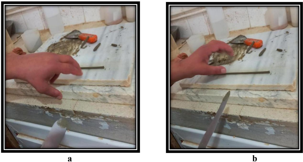
Figure III.12: Détermination de la limite de plasticité : (a) Préparation des bâtons ; (b) test.
