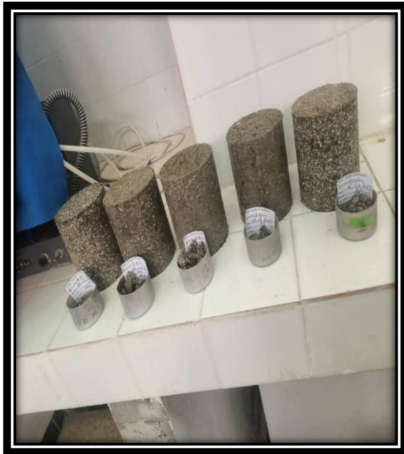
Figure III.15 : Réalisation des éprouvettes pour les essais de durabilité.
