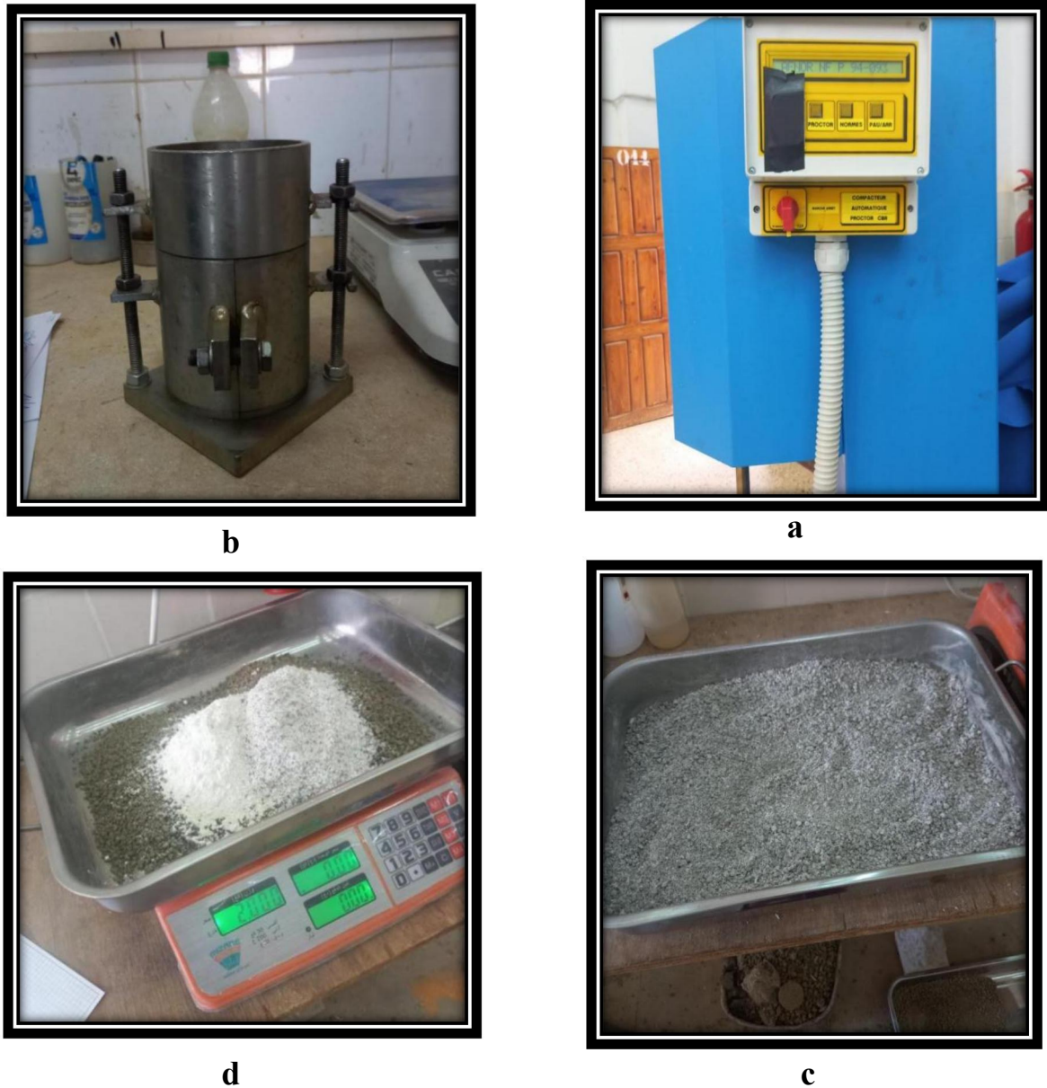
Figure III.13: Etapes de l'essai Proctor ; (a): Dame Proctor ; (b): Moule Proctor ; (c)et(d): mélange échantillon + P.V.C+ CHAUX.
