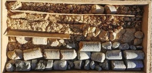
➤➤ Sondage carotte N°06 Profondeur 0.00-9.00m
