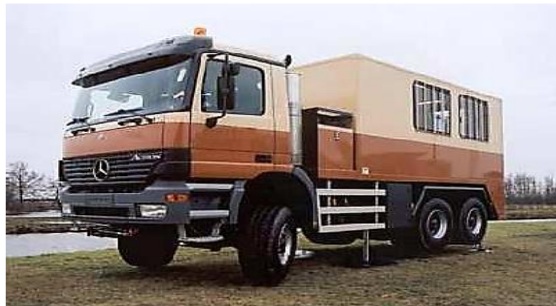
Figure 2.3 : Pénétromètre Gouda 200 KN porté sur camion
