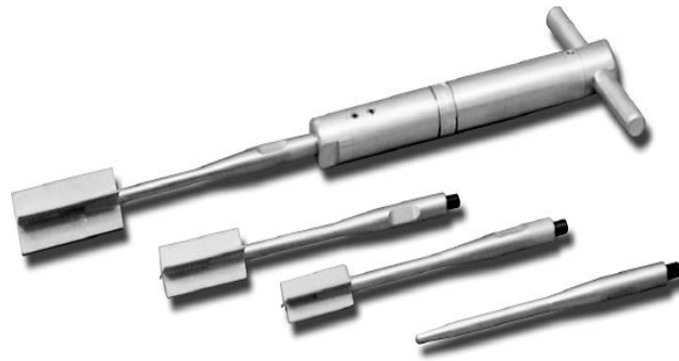
Figure 2.21 : Scissomètre modèle H-60 avec palettes interchangeables
