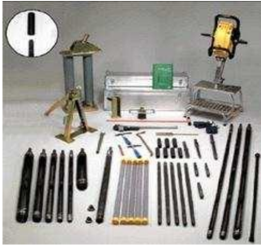
Figure 2.1 : Carottiers motorisés pour le sondage et l'échantillonnage de sols.
