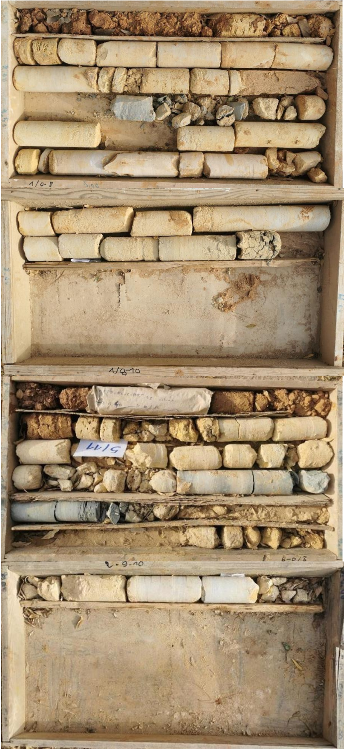
➤➤ Sondage carotte N°01 Profondeur 0.00-8.00m
