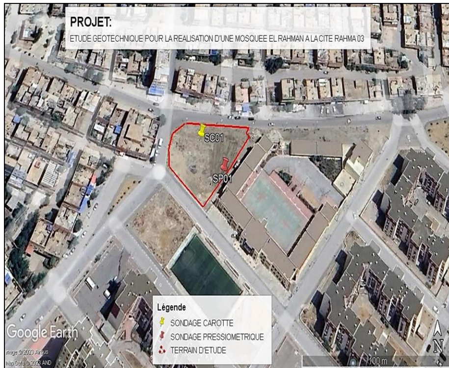
Figure 3.21 : Implantation Des Sondages
