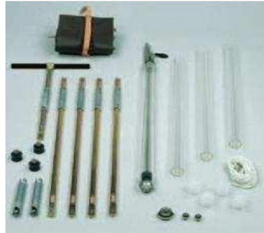
Figure 2.2 : Carottiers manuels pour l'échantillonnage non remanié de sédiments en bassin.
