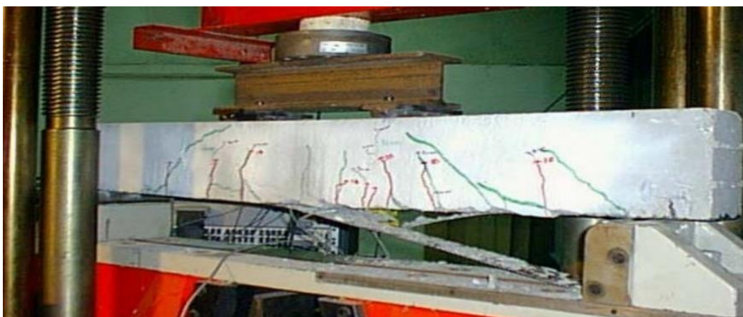
Figure III.7 : Rupture d'une poutre renforcée par décollement du renfort (BOUACHRIA and KARI, 2021)
