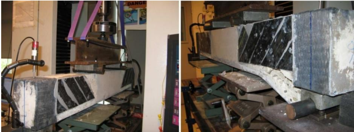
Figure III.4 : Essai flexion 4point sur une poutre BA renforcée avant et après la rupture par peeling-off. (Boulaziz A.2014)
