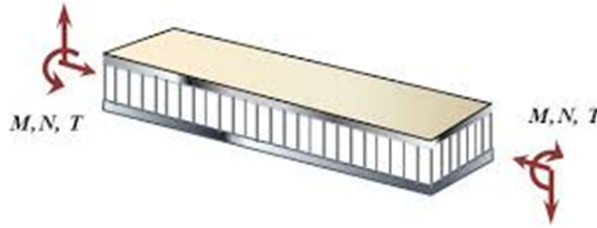
Figure II.5. Différences sollicitations (M, N, T) appliqués à un sandwich
