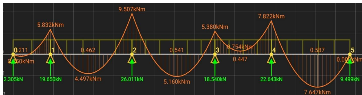
Figure III.7 : Diagramme des moments à poutre de cinq travées
