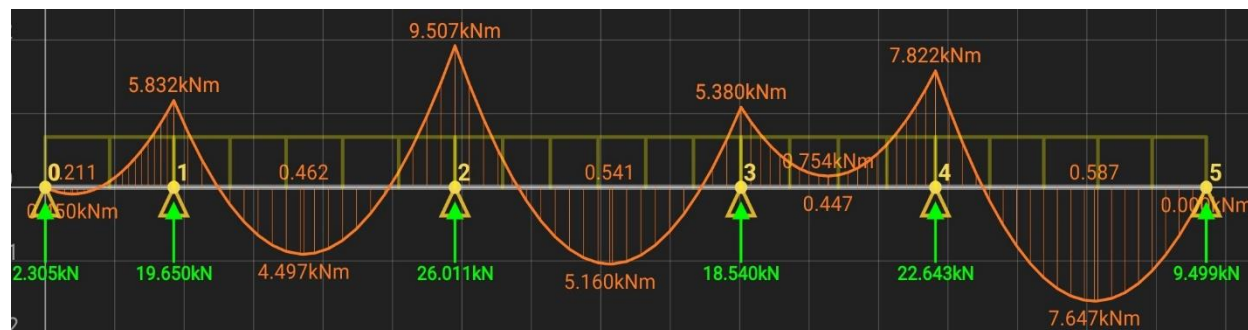
Figure III.14 :Diagramme des moments à poutre de cinq travées
