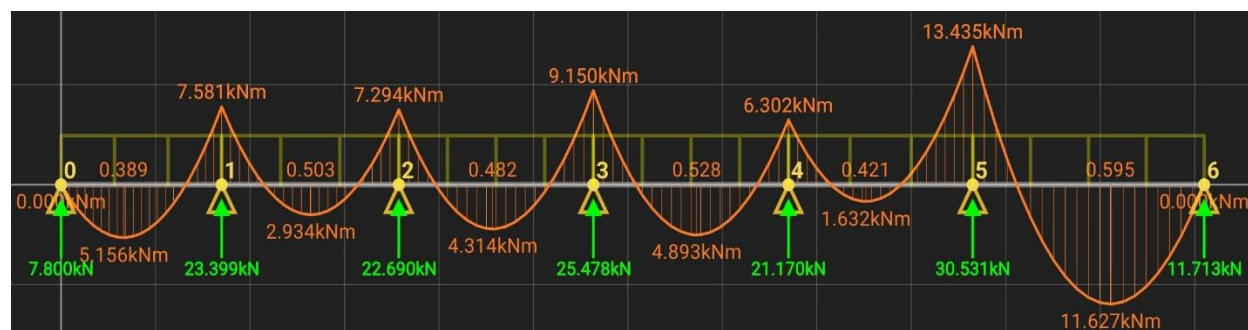
Figure III.16 :Diagramme des moments à poutre de six travées
