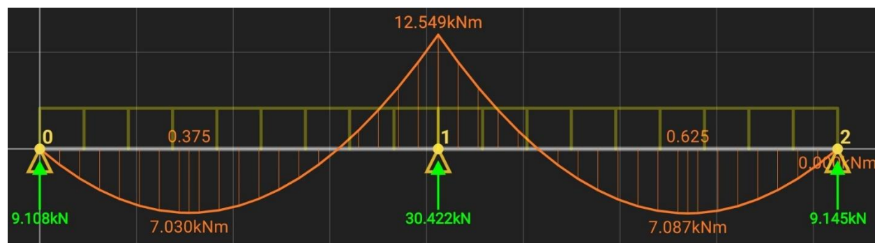
Figure III.12 :Diagramme des moments poutre de deux travées
