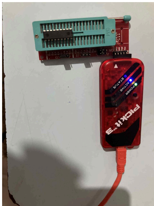
FIG. 24 : Programmation du microcontrôleur PIC à l'aide du programmeur PICKIT
