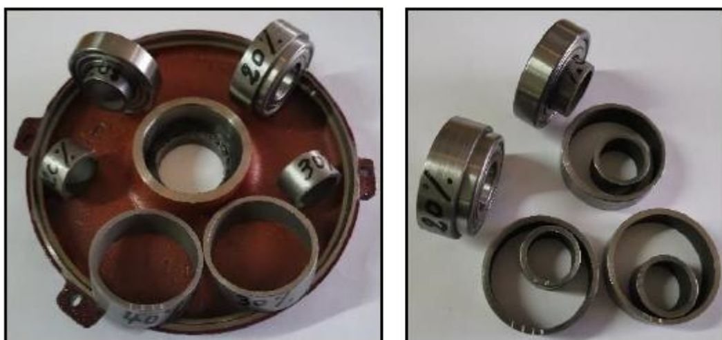
Figure III.2 Procédure de création du défaut d'excentricité
