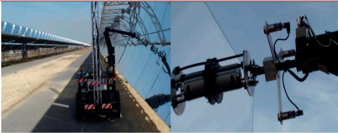
Figure 12. Mesurer la réflectivité du miroir - central énergétique Valle par MainBOT [1]
