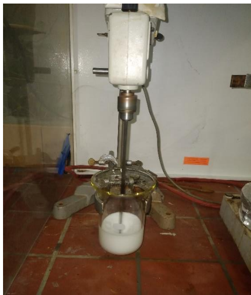
Figure II.6 : Le montage utilisé dans la préparation des microsphères
