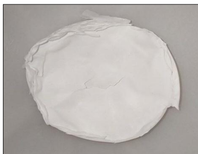
Figure .II.5 : Film obtenu de PHBV pure
