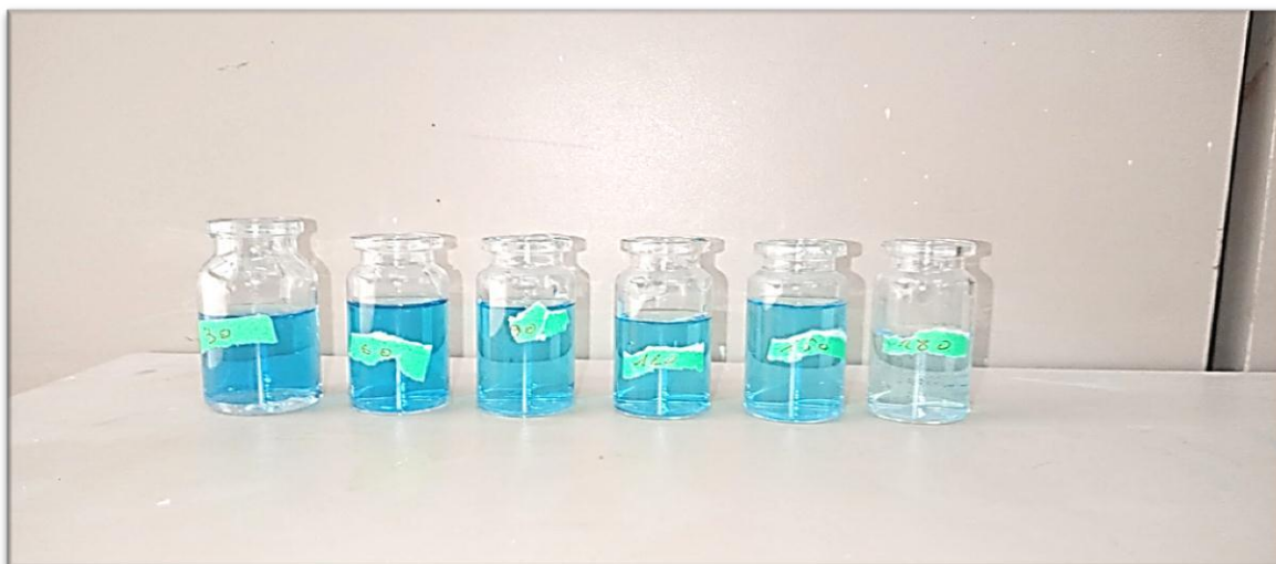
figure 35 : Résultat de la dégradation photocatalytique du bleu de méthylène par le catalyseur \text{MgBi}_2\text{S}_4
