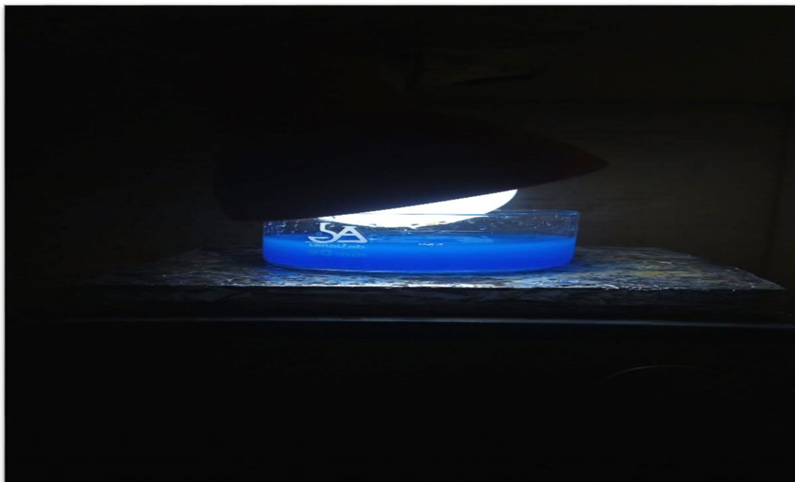
figure 30 : Réacteur photocatalytique utilisé avec une lampe visible
