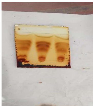
Figure.II.28 : Révélation des taches par des vapeur I 2
