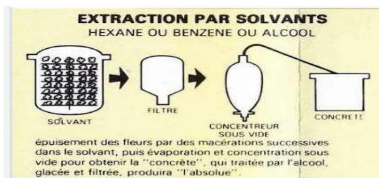
Figure. I.12: Schéma de l'extraction par solvant.
