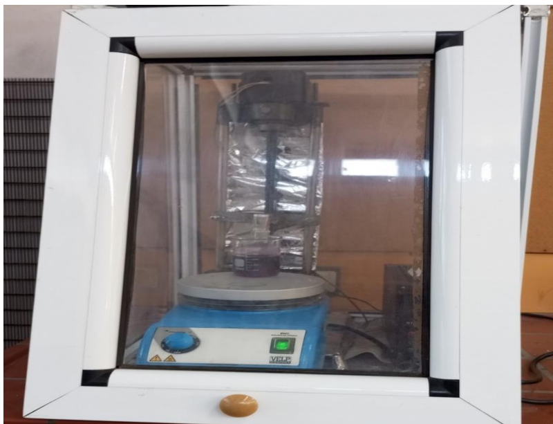
Figure II.6: Dispositif expérimental utilisé pour la technique Dip-Coating.
