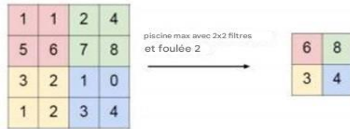
Figure IV.7: Max-pooling avec un filtre 2×2 et un pas (stride) de 2 [7].
