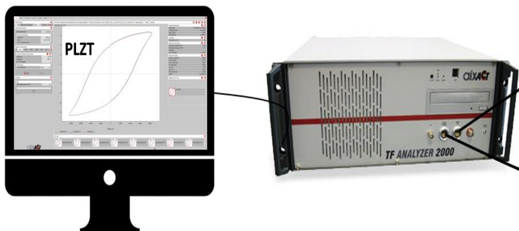
Fig. III-15 : Dispositif de mesure du cycle d'hystérésis
