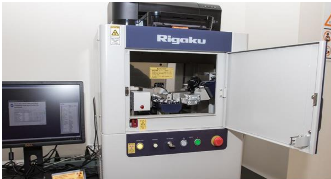
Figure III-2: Dispositif de diffraction des rayons X sur poudres (MiniFlex 600 W-Rugaku)
