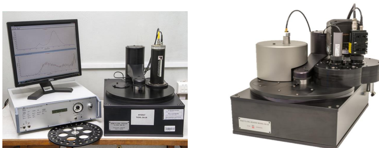
Figure III-4: Dispositif de thermoluminescence - Riso TL/OSL modèle DA-20
