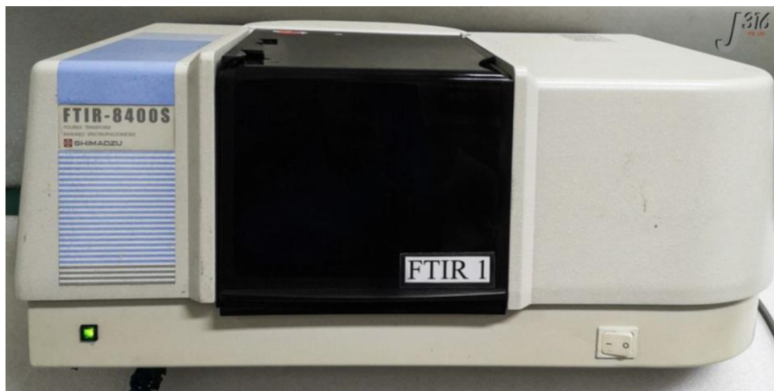
Figure III-3: Spectrophotomètre FT-IR de type SHIMADZU FT-IR-8400
