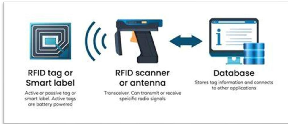
Figure 4: Étapes du processus d'identification RFID
