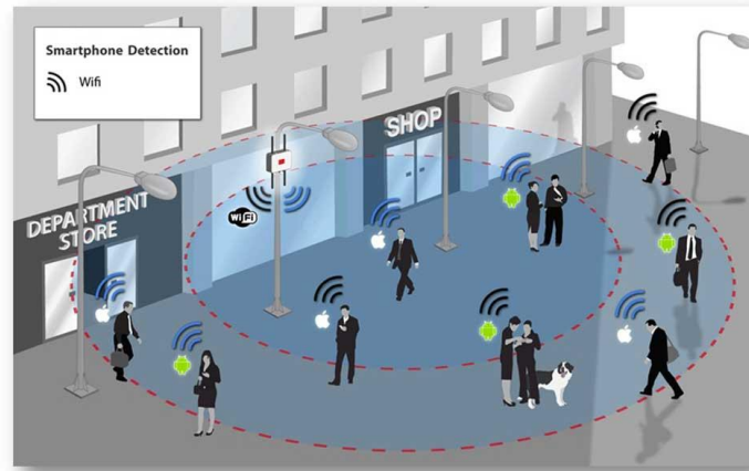
Figure 2: Localisation indoor basée sur Wi-Fi
