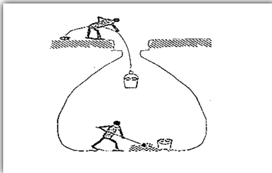
Figure 2: préparation d'une matmoura souterrain (Bartali et al, 1984)
