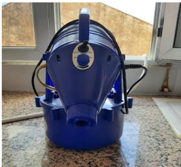
Figure N°21 : L'appareil de désinfection des surfaces et sol par voie aérienne (SCTMR EPSP Tiaret, 2025).
