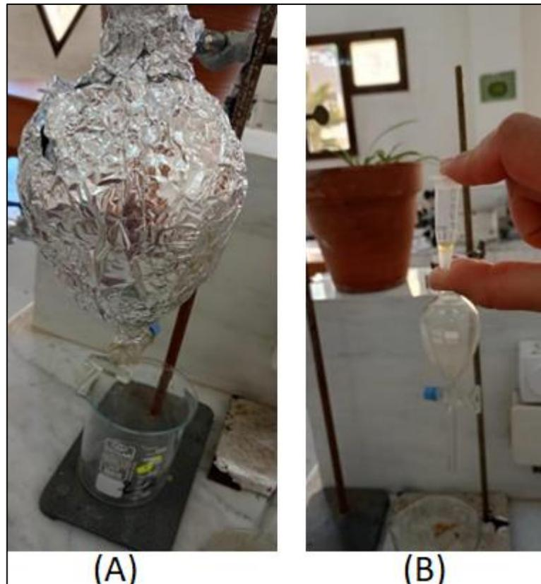
Figure 14 : a) décantation d'huile, b) L'huile obtenu.
