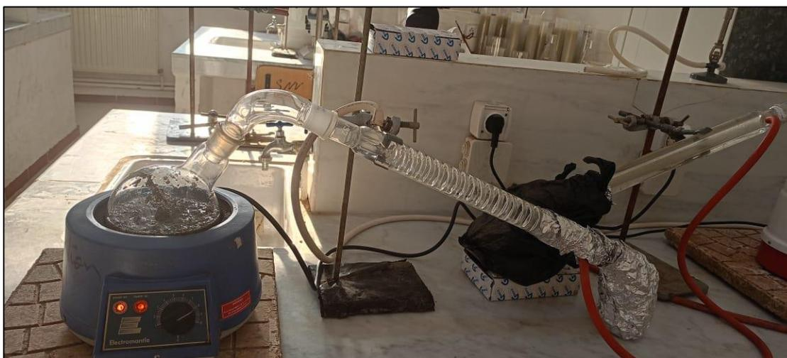
**Figure 13 :** Dispositif d'hydrodistillation
