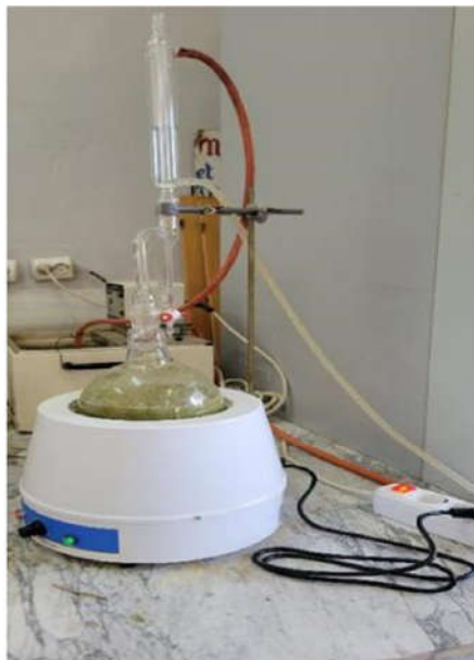
Figure 15 : Montage d' Hydrodistillation de type Clevenger. (Photo Zennoud ,Attafi et Reghioui ,2025)
