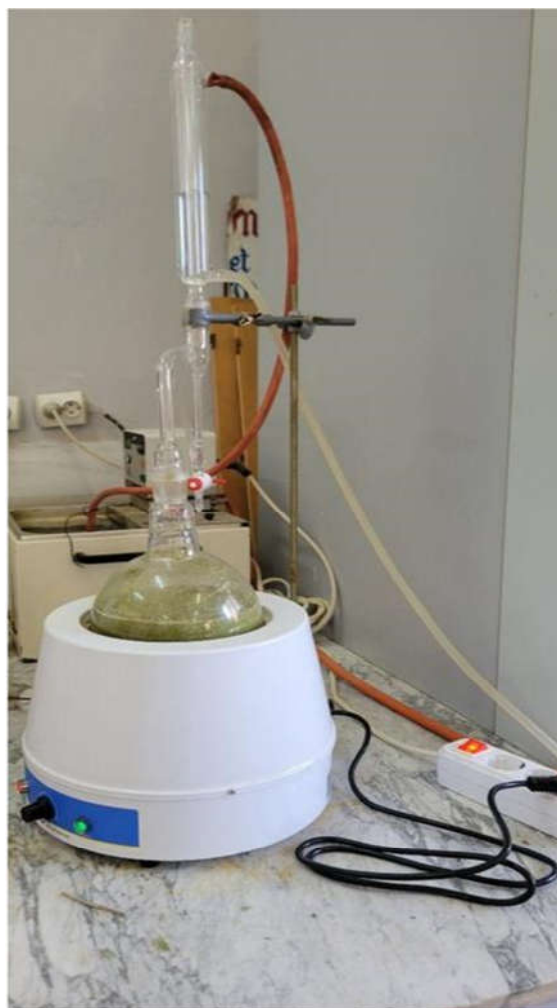
Figure 05 : Montage d' Hydrodistillation de type Clevenger. (Photos , Zennoud ,Attafi et Reghioui ,2025)
