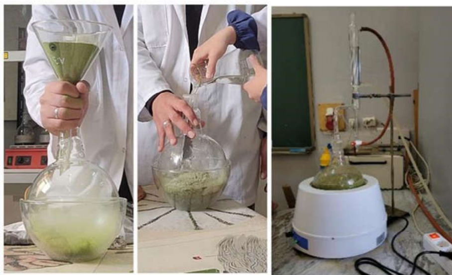
Figure 18 : Montage D'hydrodistillation (Clevenger) (Photo Zennoud ,Attafi et Reghioui ,2025)
