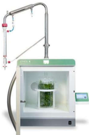
Figure 08 : Montage d'extraction assistée par micro-ondes .
