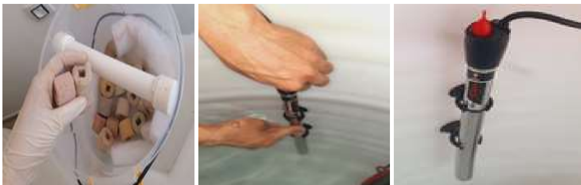
Figure 8. Système de filtration et de chauffage thermique.
