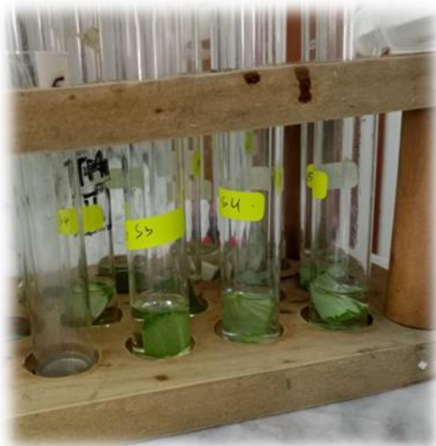
Figure 08 : Extraction des sucres par macération des feuilles des variétés de la fève ( Vicia faba L.) dans l'éthanol
