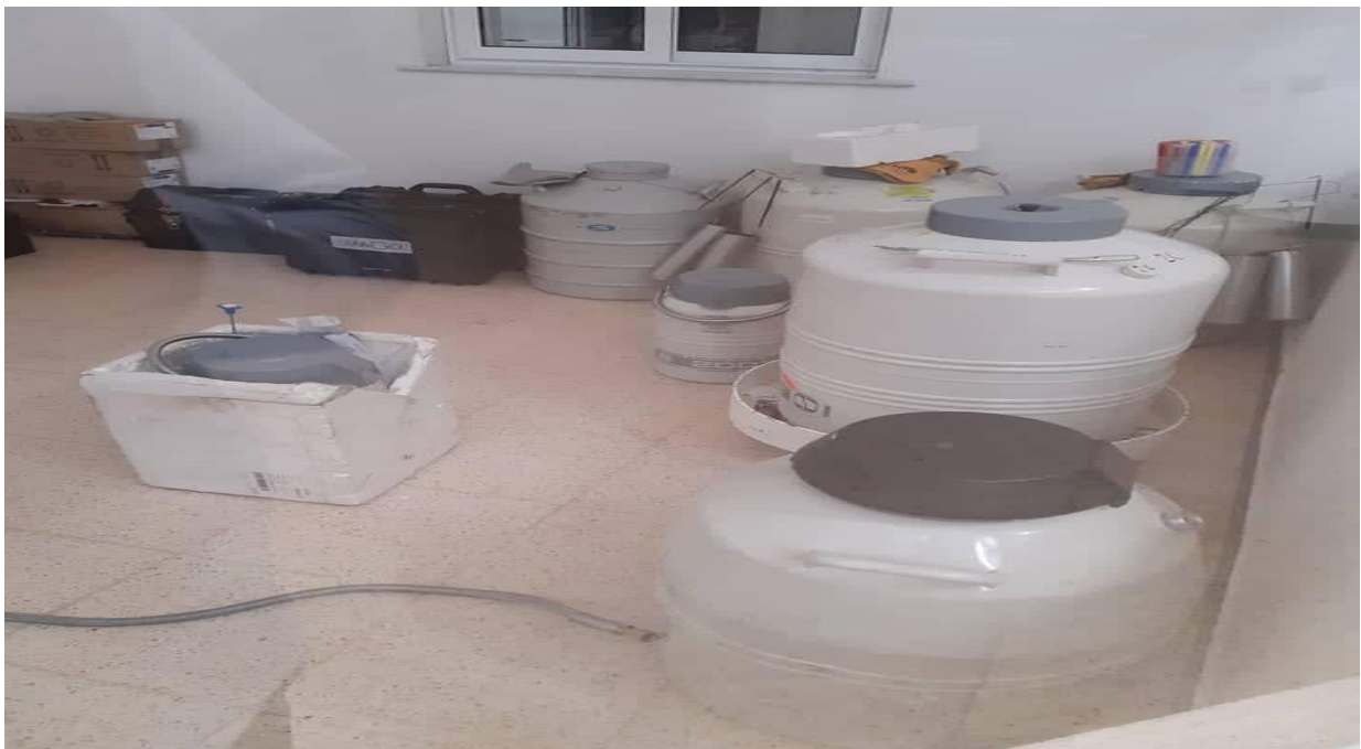
Figure 36 Cuves d'azote liquide pour la conservation de la semence.
