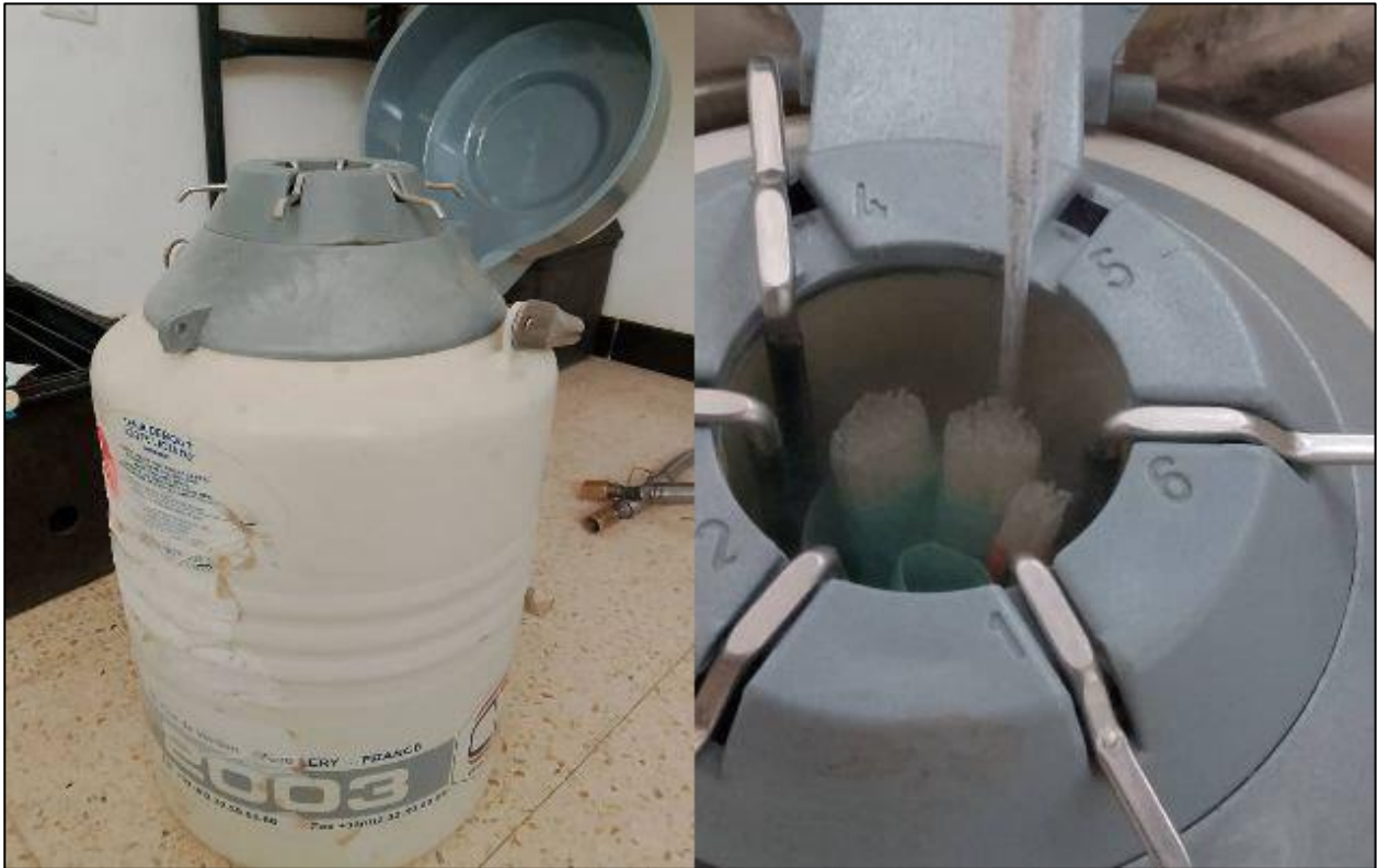
Figure 13 "Transfert et conservation dans l'azote liquide à une température de -196^{\circ}\text{C} "
