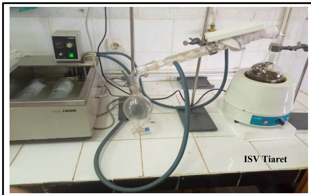
Figure 2.4 : Dispositif d'hydro-distillation utilisé lors d'extraction des huiles essentielles.
