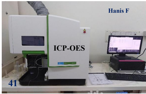
Figure 41- 42 : La détermination des éléments traces dans les échantillons de Thon en conserve par ICP-OES et CV-AAS
