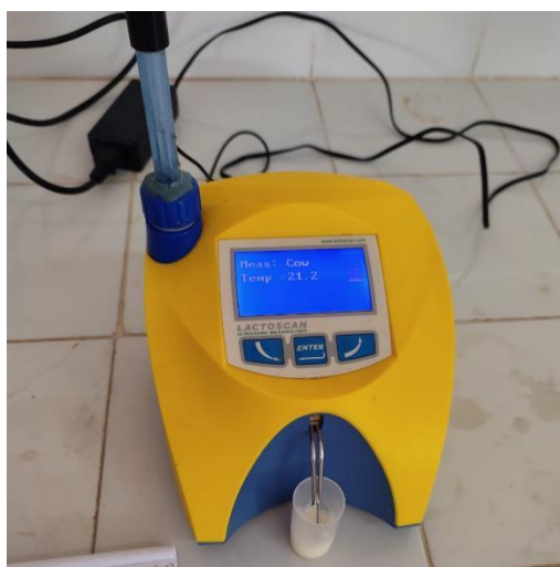
Figure 33 : Analyseur ultrasonique de lait (Lactoscan SP).
