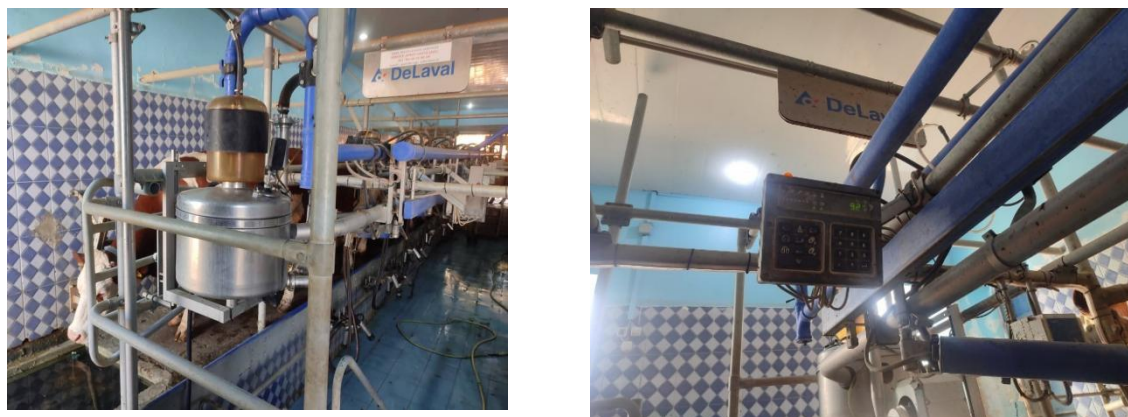
Figure 32 : La salle de traite dont les machine à traire sont liées à des compteurs pour la mesure de la quantité du lait.
