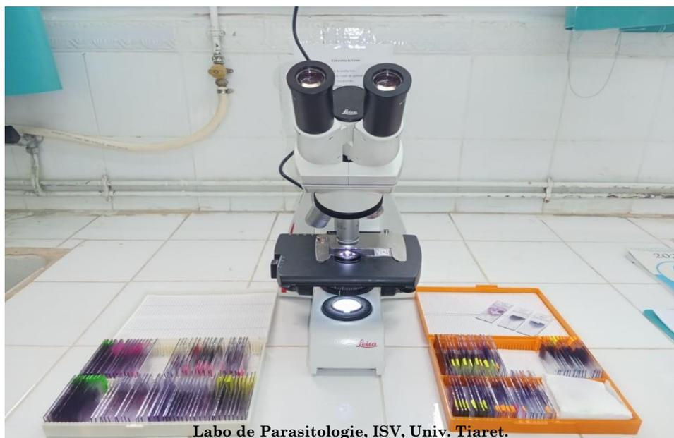
**Figure 35.** Observation des frottis sanguins au microscope optique (grossissement 1000x).
