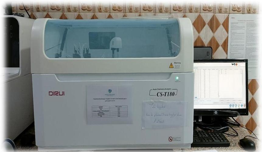
Analyseur de chimie automatique (modèle : CS-T180).
