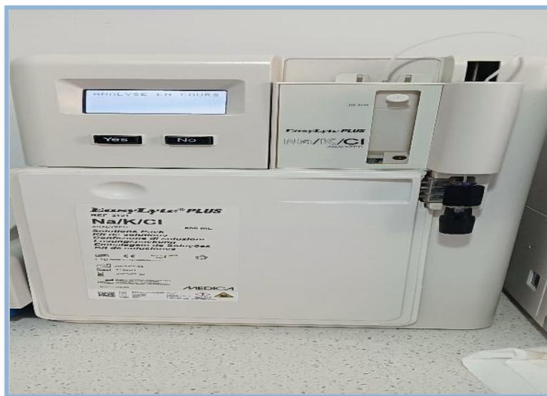
**Figure 15:** Analyseur MEDICA Easylyte Na, K, Cl.
