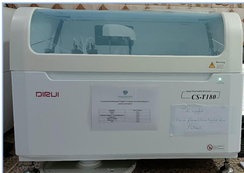
**Figure 14** : Analyseur de chimie automatique (modèle : CS-T180).
