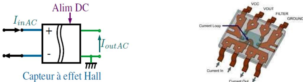
Figure 5.11 – Schéma du capteur de courant basé sur le principe de l'effet hall (doc : Allegro ACS712)
