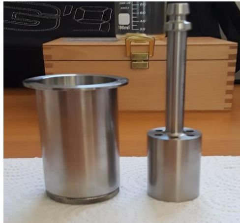
Figure II.10 : Géométrie de mesure : cylindres à double entrefer concentriques
