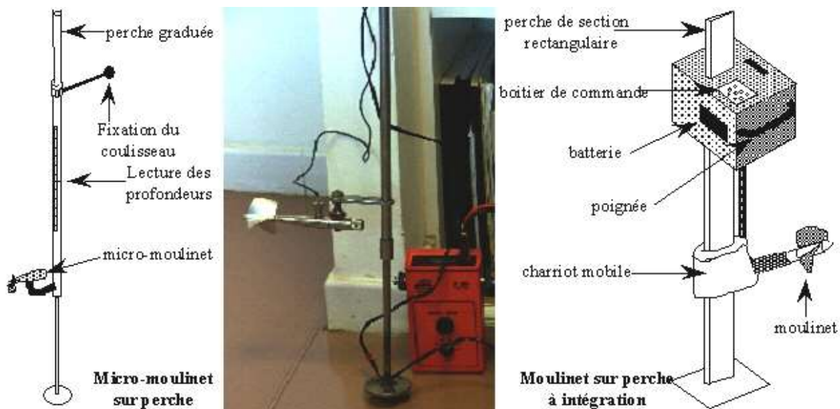
Figure I. 16. Micro-moulinet sur perche et moulinet sur perche à intégration (Laborde, 2007)
