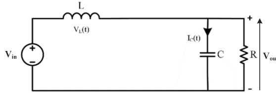
FIGURE II.3 – Convertisseur Boost (interrupteur bloqué).
