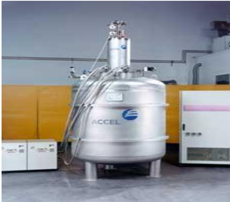
Figure 1.7 Une bobine Supraconductrice de stockage d'énergie de 2MJ [17]
