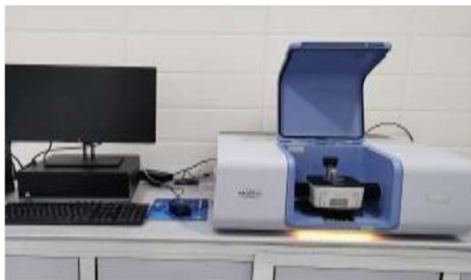
Figure II.13 : Spectrophotomètre à transformée de FTIR-8400 de type SHIMADZU,
