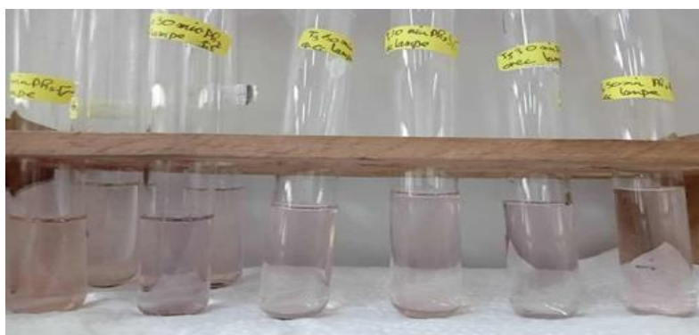
Figure II.13 : Dégradation photocatalytique du RC par ZnMn_2O_4 biosynthétisé
