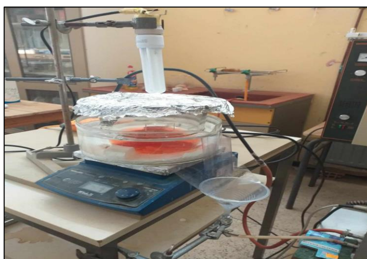
Figure II.10: Montage de la dégradation de RC
