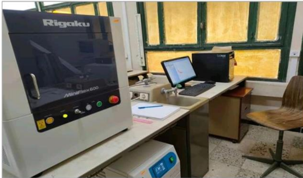
Figure-17: Diffractomètre de rayons X de marque Rigaku MINIFLEX 600.
