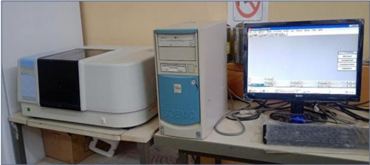
Figure-18: Spectrophotomètre SHIMADZU FTIR-8400.
