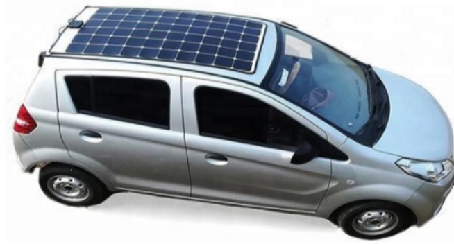
Fig. I.7 Montage d'un Véhicule électrique à panneau solaire.
