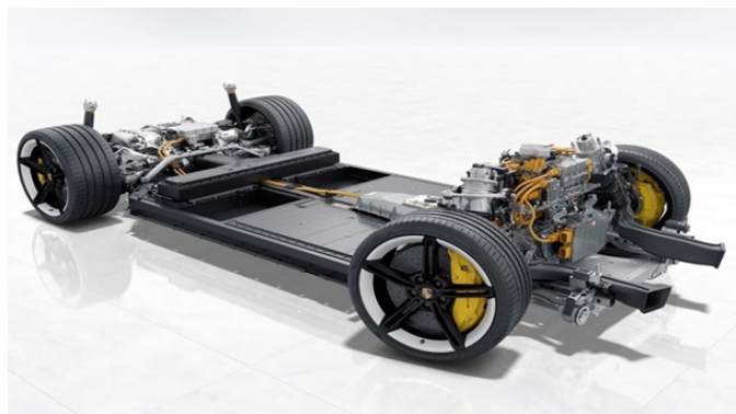
Fig. I.11 Positionnement Des Moteur dans VE.
