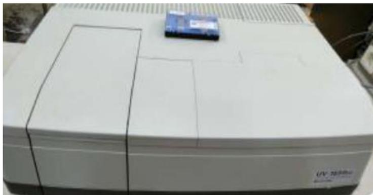
**Figure II.10** : Spectromètre UV visible
