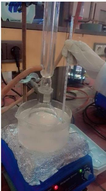
Figure II.4 : Montage de synthèse de la résine prépolymère
