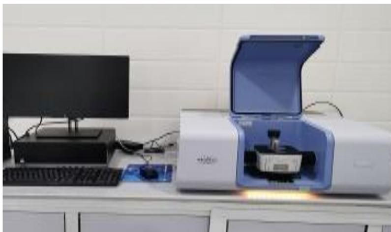
**Figure II.12 :** Spectrophotomètre à transformée de FTIR-8400 de type SHIMADZU,
