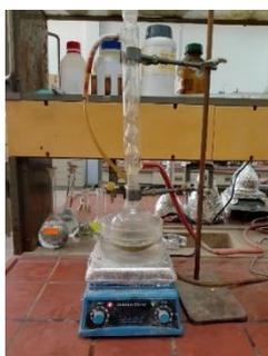
Figure 21 : Purification par le montage à reflux
