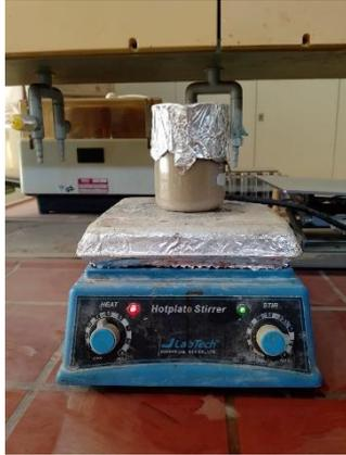
Figure 22 : Purification par attaque basique
