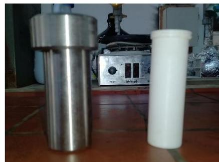
Figure 18 : Autoclave utilisé et sa chemise en téflon
