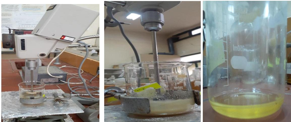
**Figure III.25:** Agitation mécanique d'huile avec l'argile
