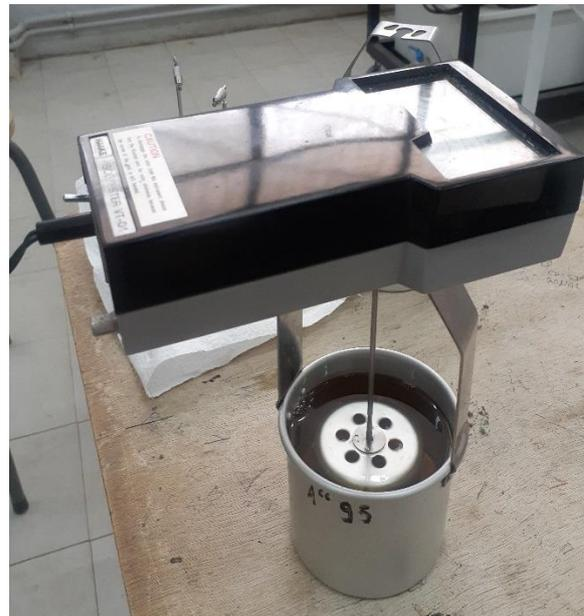
**Figure III.20:** Le viscosimètre
