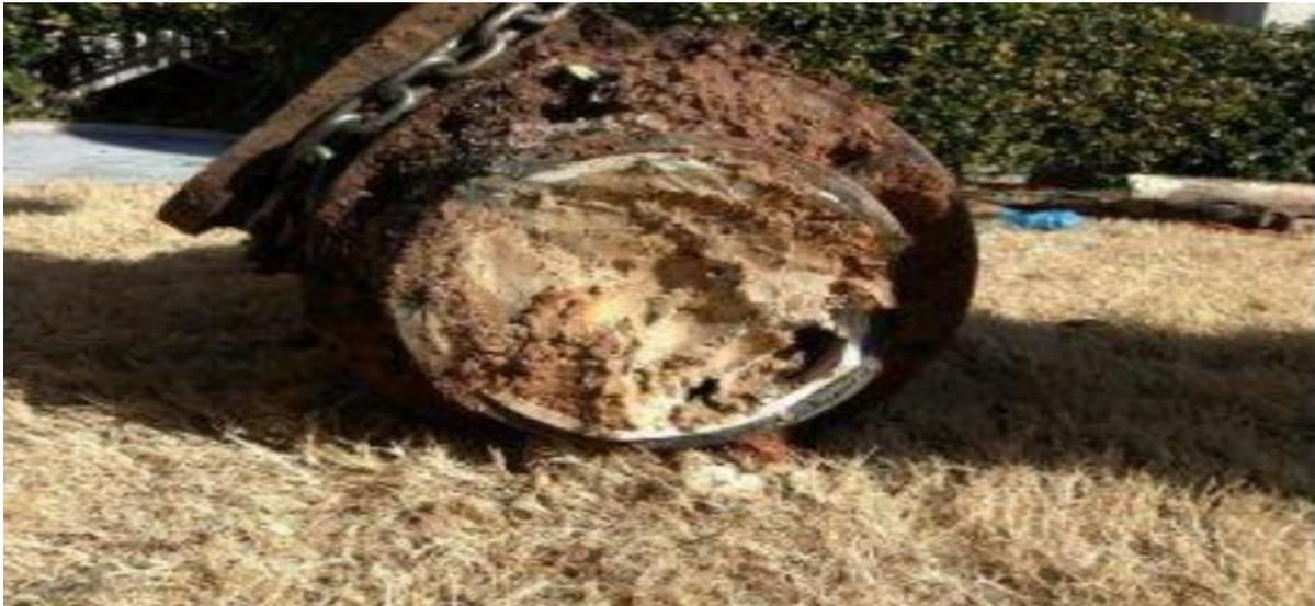
**Figure I.4 :** Canalisation bouchée à cause des huiles [13]
