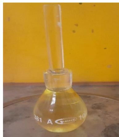
Figure III.18: Pycnomètre vide et le pycnomètre remplie par l'huile alimentaire usagée
