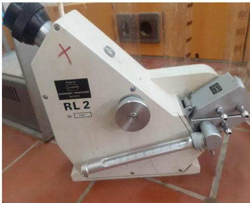
Figure III.21: Réfractomètre
