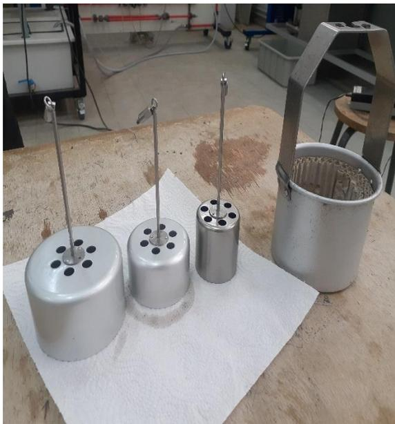
**Figure III.19:** Rotors du viscosimètre
