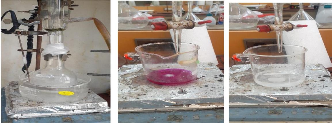
Figure III.24: Montage de l'indice de saponification (IS)
