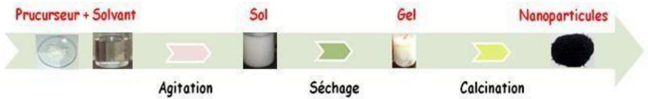
Figure I.10 : Etapes de synthèse Sol-Gel de nanoparticules
