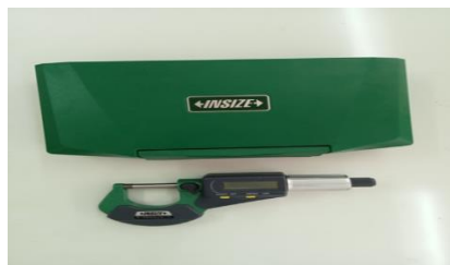
Figure III.15. Jauge de mesure d'épaisseur.
