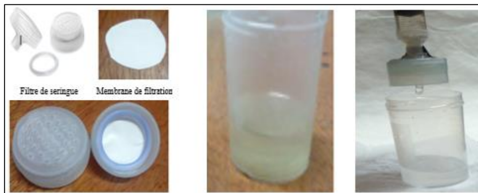
Figure III.30. Filtration de l'eau contaminée.
