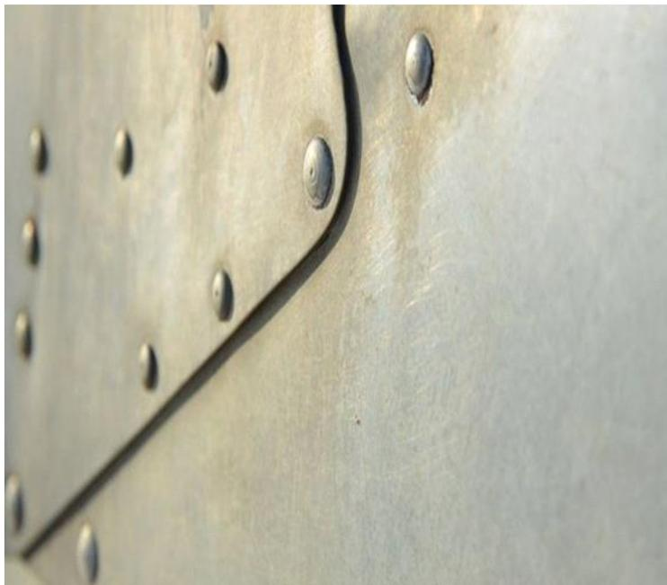
**Figure II.11** : réparation par rivetage [31]
