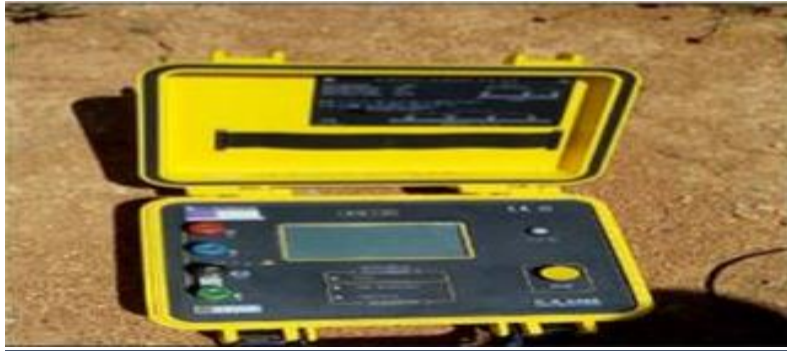
Figure I-12 Appareil utilisé pour la mesure de la résistivité du sol : telluromètre ou Géohm [25]
