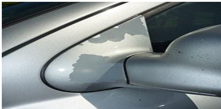
Figure II .8 : Exemple de Délaminage
