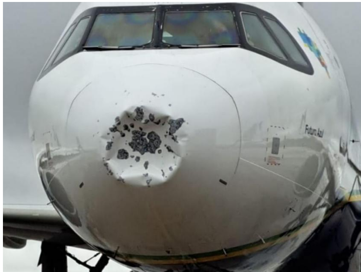
Figure II .12 Exemple de l'endommagement dans les structures aéronautiques composites
