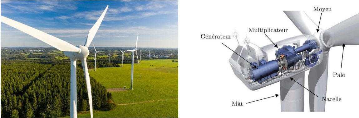
Figure I.2 : Principe de l'énergie éolienne [15]
